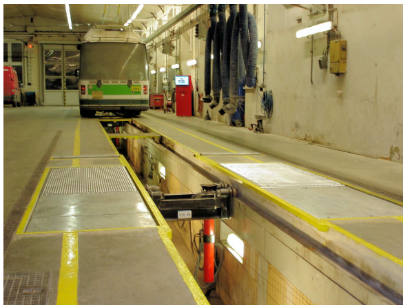
AREX LKW2PSW – zkušebny brzd s testerem sbíhavosti a integrální přejezdovou váhou (Plzeň, Zlín)
