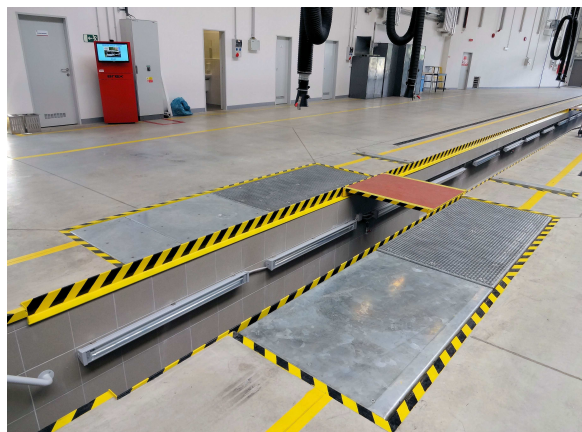
AREX LKW2PSW – zkušebny brzd s testerem sbíhavostí a integrální přejezdovou váhou (nové DEPO Plzeňských městských dopravních podniků ve ŠKODA TRANSPORTATION)
